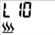
Drücken Sie Taste E (+) oder F (-), um die Temperatur einzustellen. Ist die gewünschte Heiztemperatur höher als die Raumtemperatur, beginnt das Gerät zu heizen. Ist die gewünschte Heiztemperatur unter der Raumtemperatur, wird das Gerät nicht heizen.
