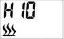
Drücken Sie Taste E (+) oder F (-), um die Temperatur einzustellen. Ist die gewünschte Heiztemperatur höher als die Raumtemperatur, beginnt das Gerät zu heizen. Ist die gewünschte Heiztemperatur unter der Raumtemperatur, wird das Gerät nicht heizen.
