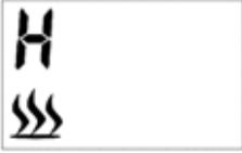
Drücken Sie die Taste C (OK), um die Temperatur einzustellen. Die eingestellte Standardtemperatur ist 10°C und wird wie folgt angezeigt:
