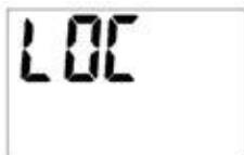
Halten Sie die Taste C (OK) für mindestens 6 Sekunden gedrückt, um die Tasten zu sperren oder zu entsperren. Tun Sie das, erscheint LOC auf dem Display und zeigt an, dass die Knöpfe nun gesperrt sind. Die Anzeige bleibt für 6 Sekunden und erlischt dann. Drücken Sie einen beliebigen Knopf, um die Anzeige wieder zu aktivieren. Halten Sie die Taste C (OK) für 6 Sekunden gedrückt, um die übrigen Tasten wieder zu entsperren. Bitte beachten Sie, dass Taste B (An/Aus) niemals gesperrt werden kann.
